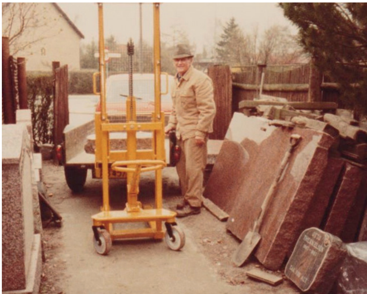
Stanley Pedersen i forhaven til Femagervej 45, maj 1983. Fotograf ukendt. I forhaven var der et lager af sten. Den gule truck brugte Stanley Pedersen til at transportere sten og til at få sten op i "huggehøjde".
